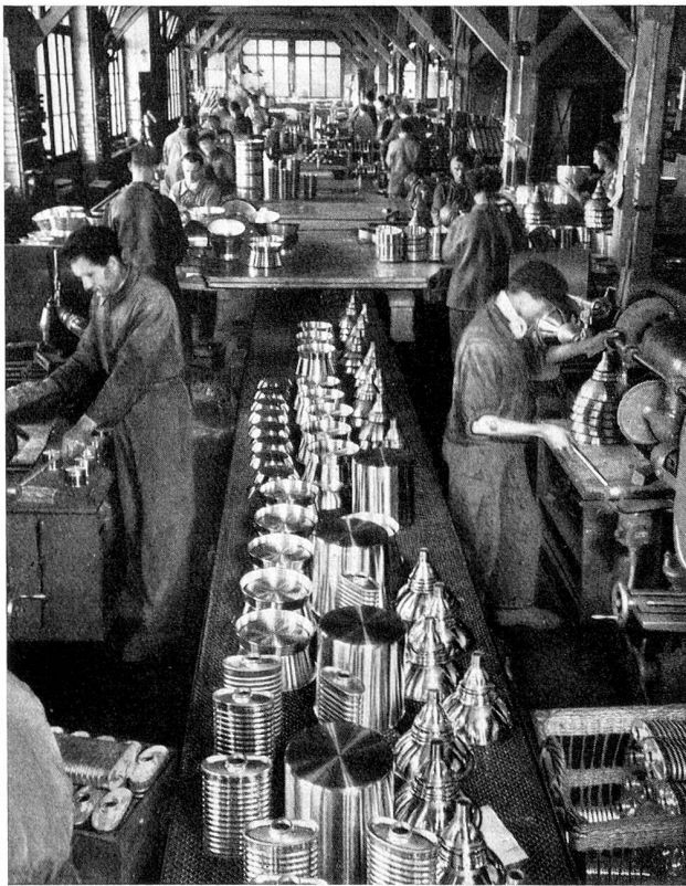
Die Artikel erhalten durch Schleifen und Polieren ihren Silberglanz
