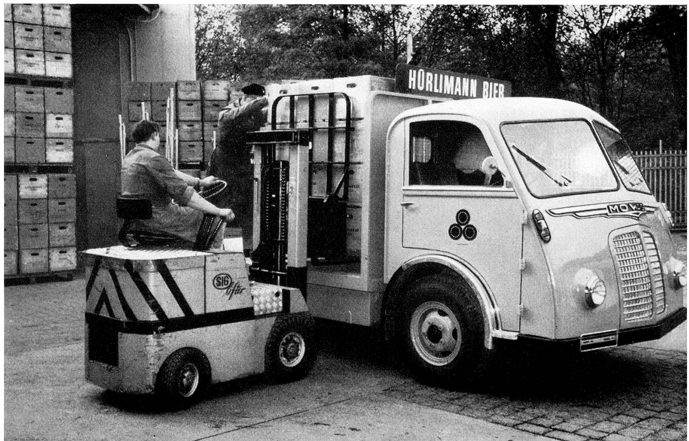
Klein-Lastwagen. Seine Besonderheit ist die niedere Brücke
