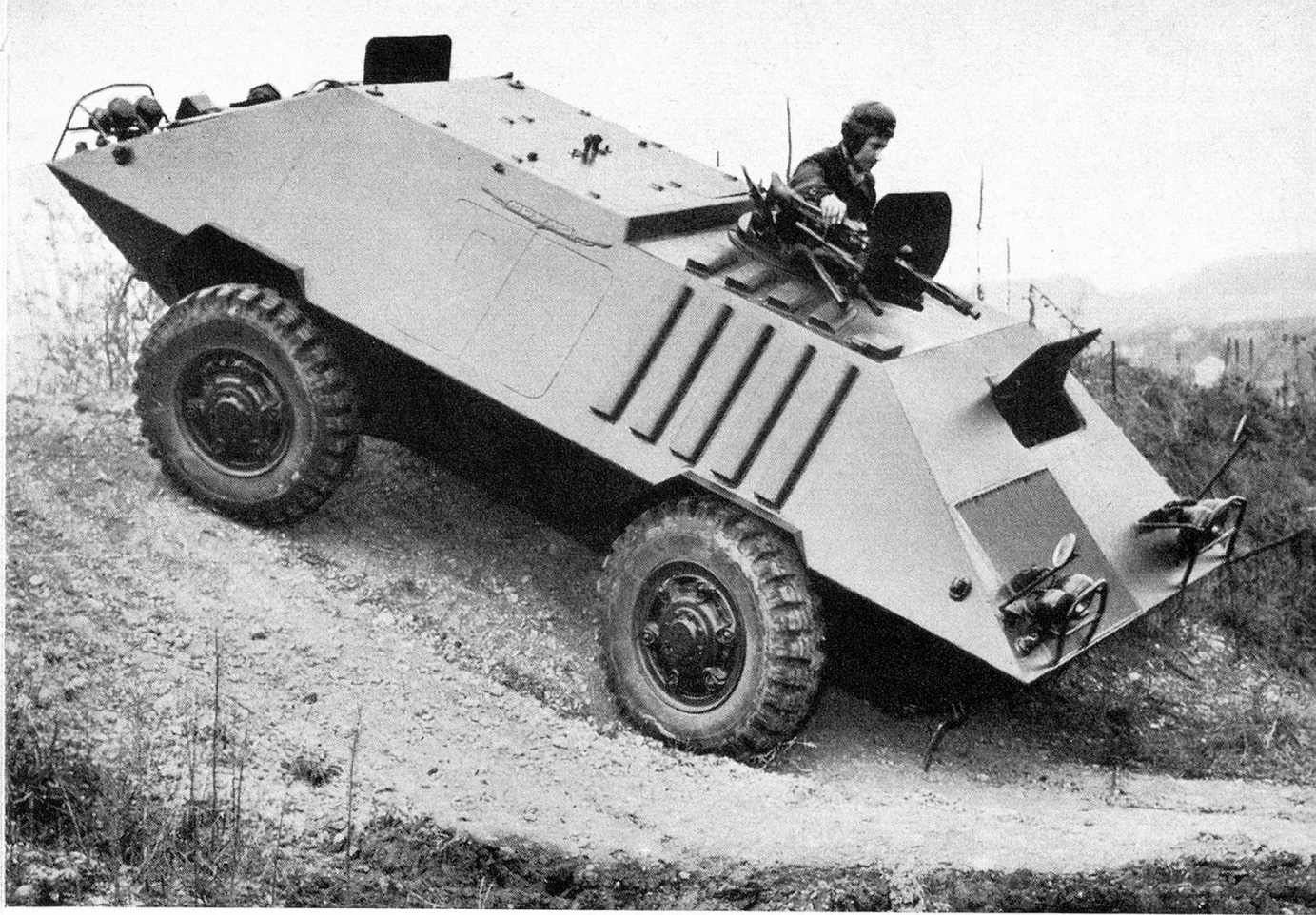
MOWAG Schützenpanzerwagen mit Doppelsteuerung und 4-Rad-Lenkung. Besatzung total 7 Mann
