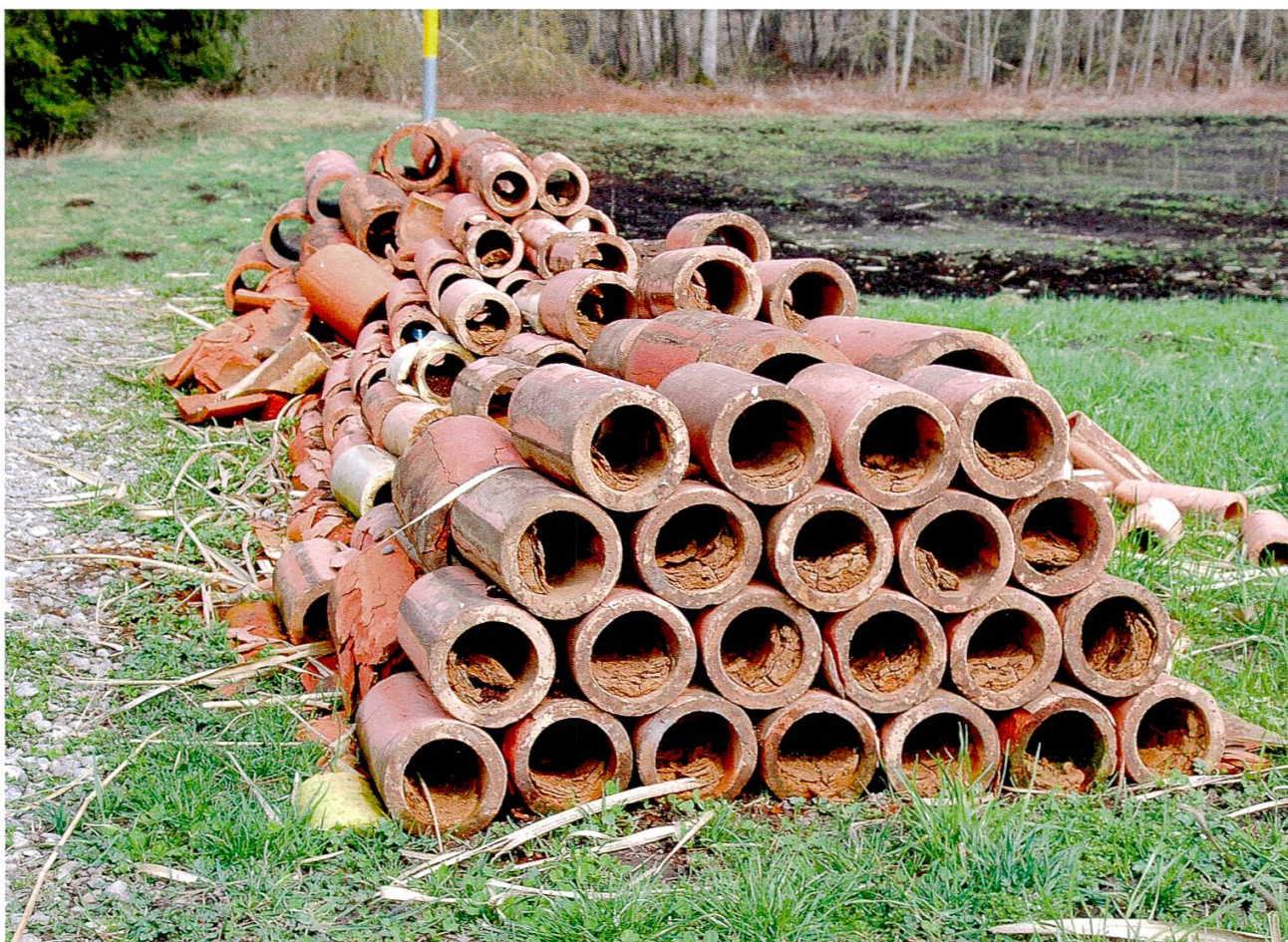
Abbildung 1: Ausgegrabene Drainagerröhren. (Foto: Joggi Rieder)
