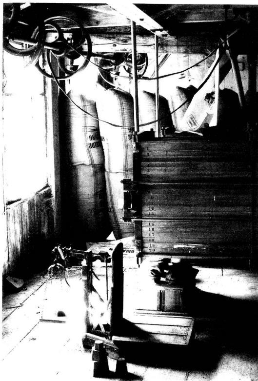
Der Plansichter – schubladenartig übereinander-gestaffelte Seidensiebe in Holzrahmen – umgeben von Waage, Transmissionen und Getreidesäcken.
