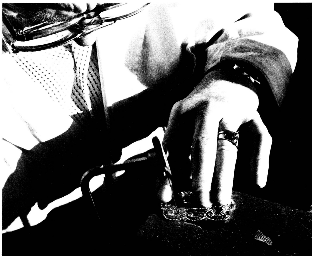
Eine der letzten Arbeiten ist das Aussägen der Durchbrüche in den Ornamentplatten.
