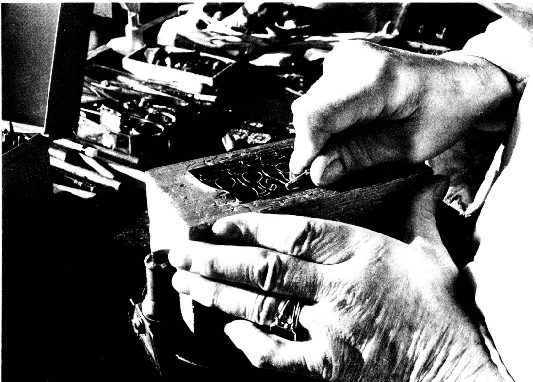
Mit dem Grabstichel werden die Konturen - hier von drei Leitkühen - in die Messingplatte ziseliert...
