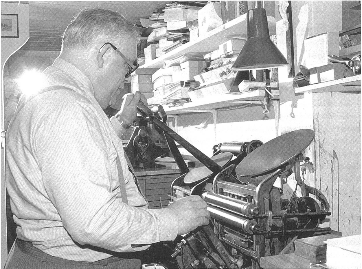
Anton Galls typografisches Reich: Er bedient den Handtiegel von 1860.
