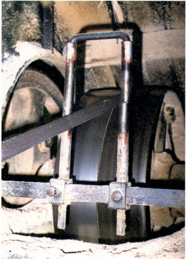
Riemenscheibe mit Leerlaufscheibe auf der Welle zwischen den beiden Exzenter-Schwungrädern. Der Riemen kann mit einer Spindel vom Sägeschoss aus verschoben werden.
