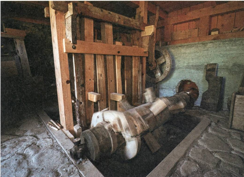
Das Wasserrad treibt die hölzerne Nockenwelle der Beistampfi sowie bei Bedarf den Siebapparat.
