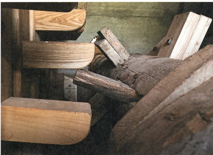
Hölzerne Nocken heben die schweren Stämpfel im Takt. Fotos: René Güttinger, Nesslau.
