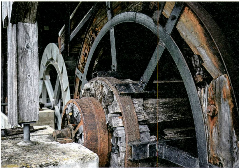
Einst vom Wasserrad angetrieben: das Walliser Hammerwerk.
