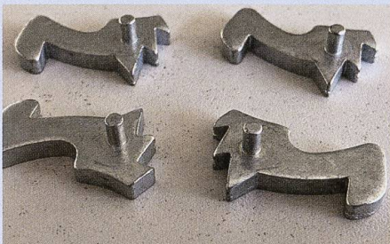
Zahnscheiben (Dicke 4 mm, Pinhöhe 5.3 mm).
