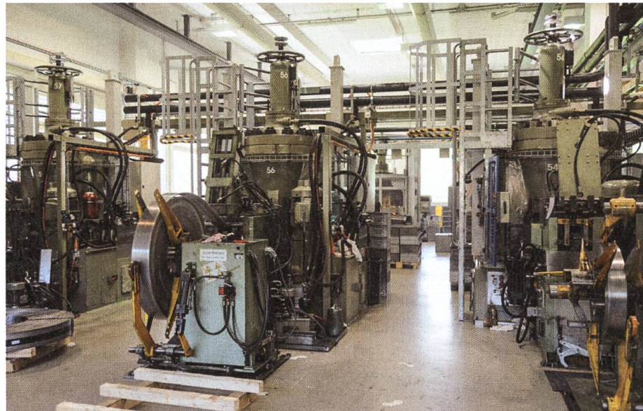
Stanzerei: Schiess-Pressen mit 3000 kN (300 t) Schnittkraft.
