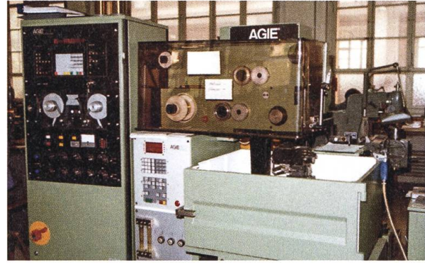
Senkerosionsmaschinen von Charmilles (links) und Drahterosionsmaschine von AGIE.
