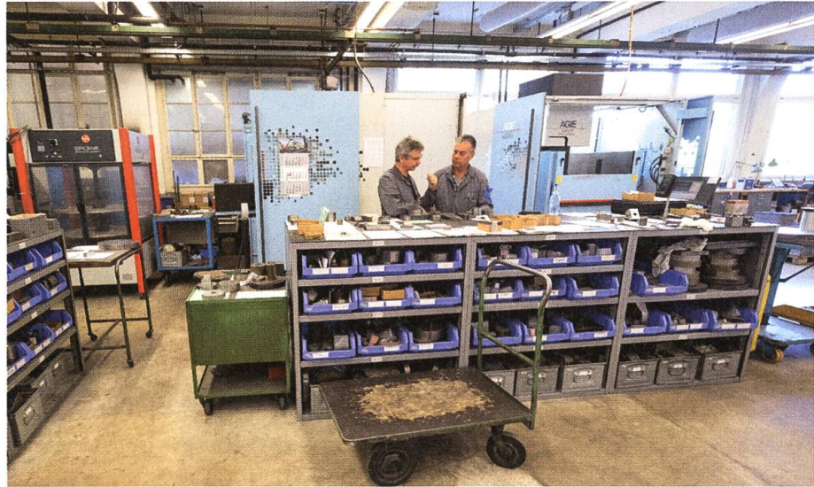
Werkzeugmacherei: Im Hintergrund die AGIE, Drahterosionsmaschinen.
