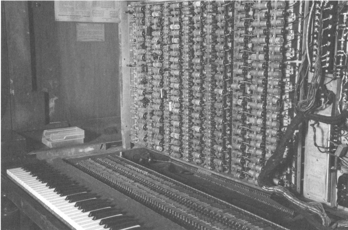
Abb. 4: Hammond Novachord, elektronisches Musikinstrument, das zwischen 1939 und 1942 von der Firma Hammond produziert wurde, Fotografie von 2017, aufgenommen im SMEM. © John Ma.
