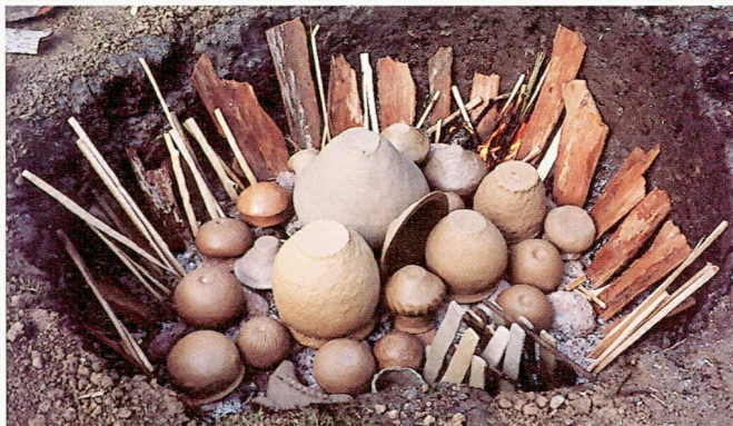
c: 15.40 Uhr, 100°: Anfeuern am Rand der Grube, vorwiegend mit langsam brennender Rinde.
