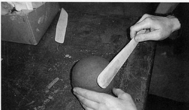
c: Mit einem Holz wird der Gefässunterteil in die Form geschlagen.
