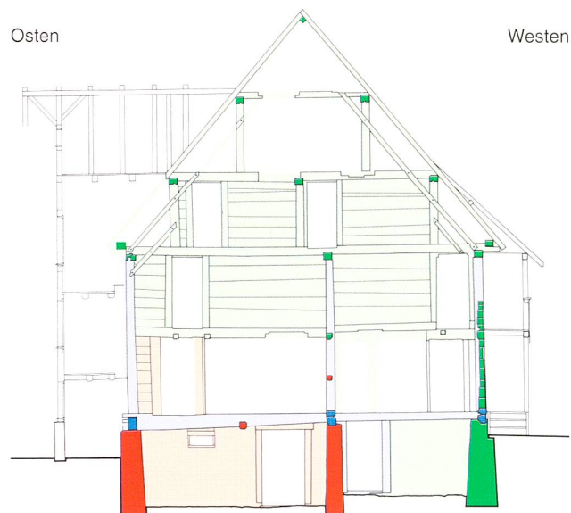
■ Bohlens-Ständer-Bau, 1315/16 ■ Bauphase um 1470 (ohne Umriss = rekonstruiert) ■ Bauphase um/nach 1680
