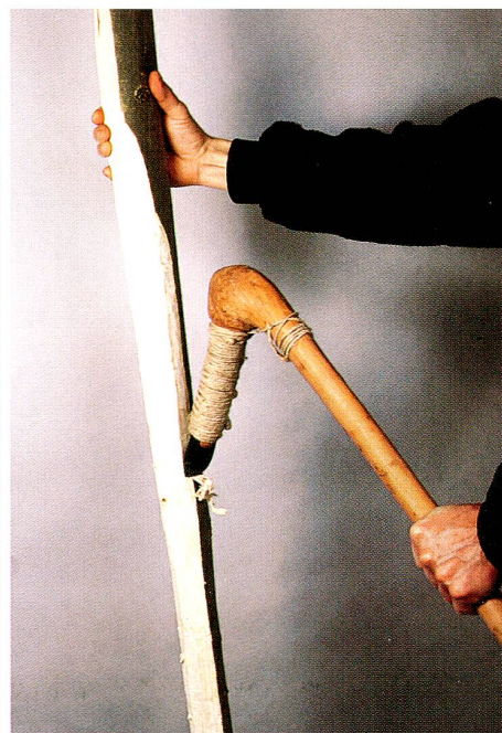
Zurichten des Holmrohlinges mit dem Dechsel.
