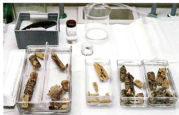
Abb. 22 Cham-Eslen. Doppelaxt. Der Holm ist in Einzelteile zerfallen. Nach dem Bleichbad ist die Birkenrinde optisch sehr gut zu erkennen. Die Holmfragmente befinden sich im ersten Austauschbad Wasser-Ethanol.
