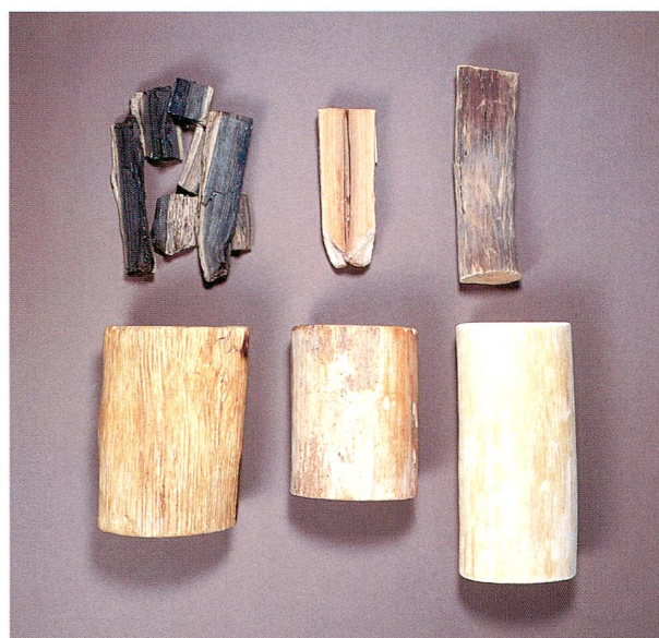
Die drei Holzproben illustrieren, was geschieht, wenn prähistorische Feuchthölzer nicht fachgerecht konserviert werden: Das Holz schrumpft, oft begleitet von einem eigentlichen Kollaps der Holzsubstanz (oben). Fachgerecht behandelte und restaurierte Proben sehen fast wie frisches Holz aus (unten).
