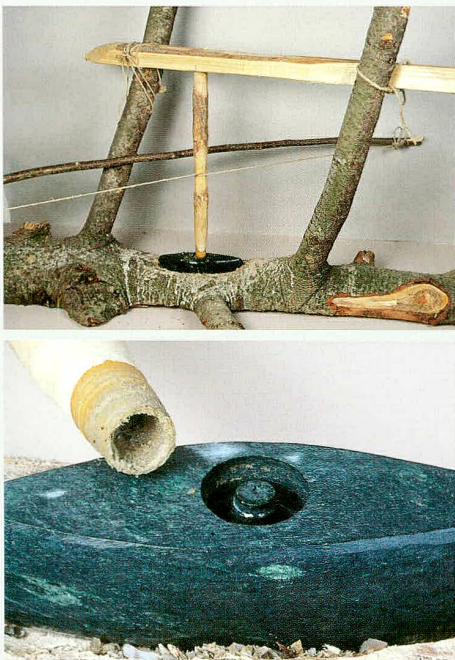
Bohrvorrichtung (oben). Bohrer und Zapfen im Bohrloch (unten).
