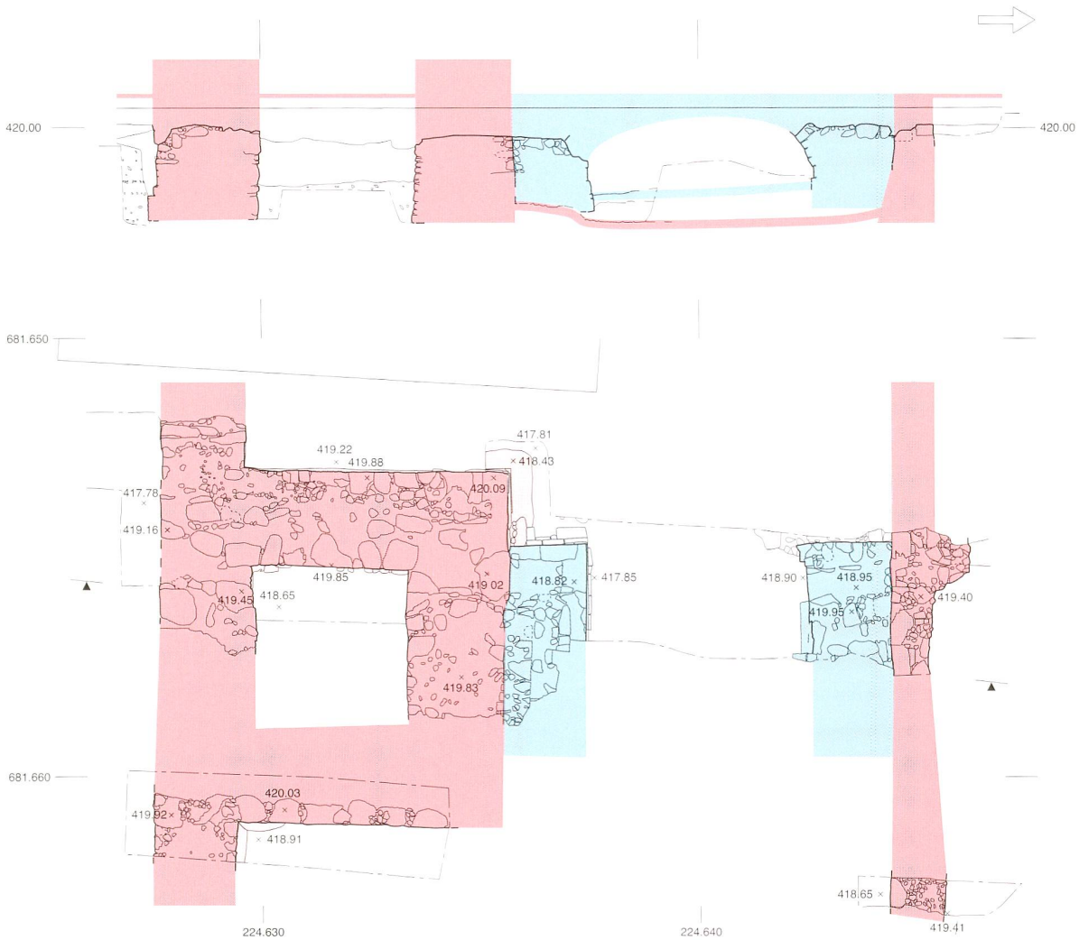
Abb. 7 Neu- oder Baarertor. Querschnitt nach Westen (oben) und Grundriss (unten) anhand der Grabungsbefunde 2004. M 1:150.
