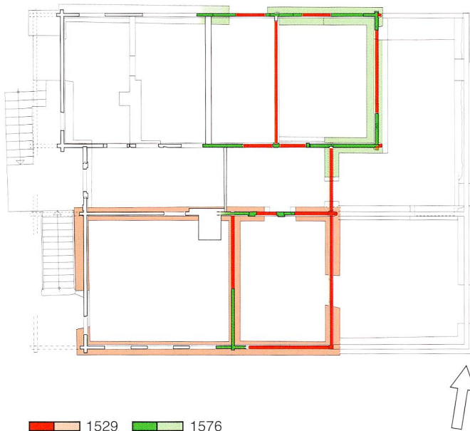
Abb. 27 Risch, Berchtwil 2. Grundriss unteres Wohngeschoss mit Kellermauern. Massstab 1:200.
