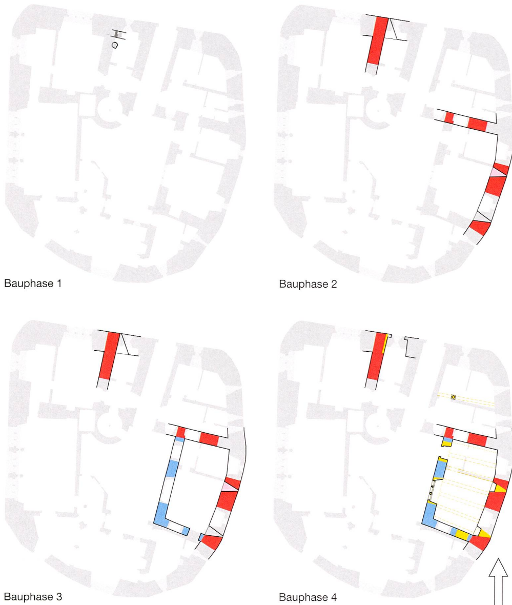
Abb. 22 Cham, St. Andreas 1, Schloss St. Andreas. Grundrisse der Bauphasen 1–4. Massstab 1:400.
