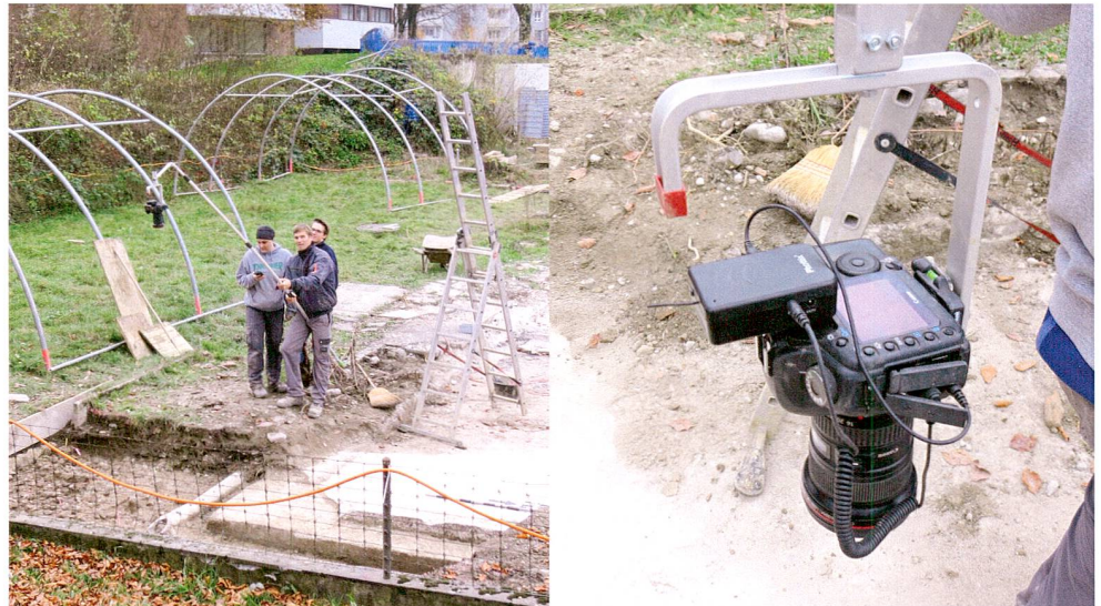
Abb. 12 Anwendung des «PhotoMob» auf der Grabung Zugerstrasse 112 in Cham (Ereignisnr. 2-448.06-12/13). Eine Person hält den Fotogalgen mit der Kamera und richtet diese über dem Motiv aus, eine zweite Person kann – ähnlich wie beim Kopter – über einen Vorschau- monitor den Bildausschnitt beurteilen und die Kamera aus- lösen.
