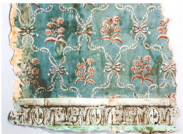
Abb. 2 Zug, Kirchenstrasse 3, erstes Obergeschoss, Oststube, Raum 1.3. Blaue Blumentapete und zugehörige klassizistische Bordüre. Tapete: grundierte Bogenrolle, Handdruck mit zwei Farben, England, um 1770/1800, Rapport 12,5 × 18,5 cm, Papierbogenmass 46,5 × 43 cm. Bordüre: grundierte Bogenrolle, Handdruck mit fünf Farben, unbekannte Herkunft, um 1770/1800, Rapport 9 × 13,5 cm, Papierbogenmass unbekannt.
