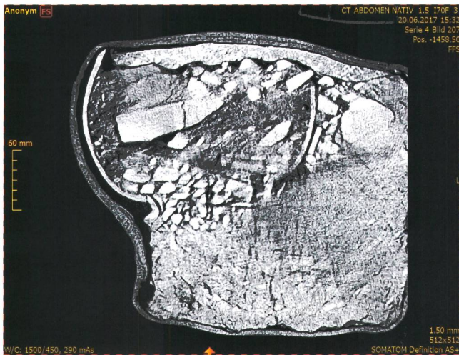
Abb. 7 Zug, Unteraltstadt 12. Computertomografie der als Block geborgenen Topfdeponierung (Pos. 271).
