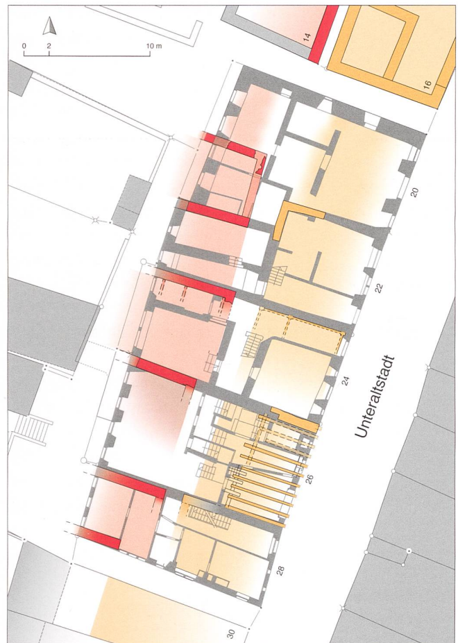
Abb. 9 Bauliche Befunde im Häusergeviert Unteraltstadt 20–28. Rot: Reste der östlichen Bebauung der einstigen «Untergass». Orange: Reste der westlichen Bebauung der einstigen «Mittelgass». Dazwischen verlief ein Ehrgaben. Nördlich des Häusergevierts ist ein kleines Stück Ehrgaben noch zwischen den Häusern Unteraltstadt 14 und 16 erhalten. Südlich des Häusergevierts wurde bei archäologischen Untersuchungen im Bereich der Häuser Unteraltstadt 30 und 32 vermutlich ebenfalls ein Ehrgaben gefasst.
