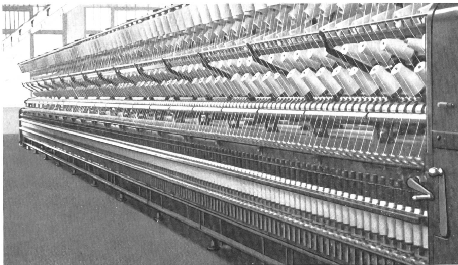
Generalansicht einer Baumwoll-Ringzwirnmachine. Bäumlin, Ernst & Co., St-Gallen.
