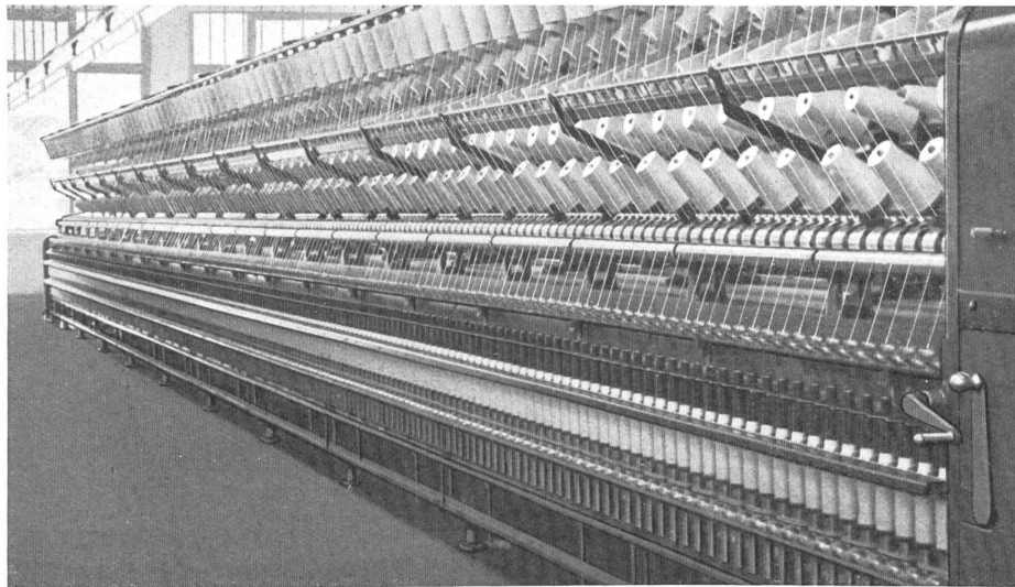
Vue générale d'une retordeuse à anneaux pour le coton. Bäumlin, Ernst & Cie, St-Gall.
