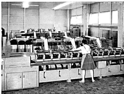
Machine ultra moderne pour l'étirage en fin dans une fabrique de laine peignée
