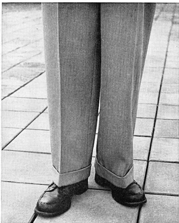
Pantalon mouillé puis séché A gauche : traité au SI-RO-SET ; à droite : non traité Trousers dried after having been wet Left : treated with SI-RO-SET, right untreated Pantalón mojado y secado A la izquierda : tratado con SI-RO-SET. A la derecha : sin tratar Die Hose wurde durchnässt und wieder getrocknet Links : mit SI-RO-SET behandelt, rechts unbehandelt
