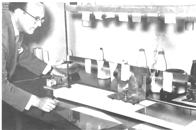
Demostrando la inflamabilidad de diversas muestras textiles.
