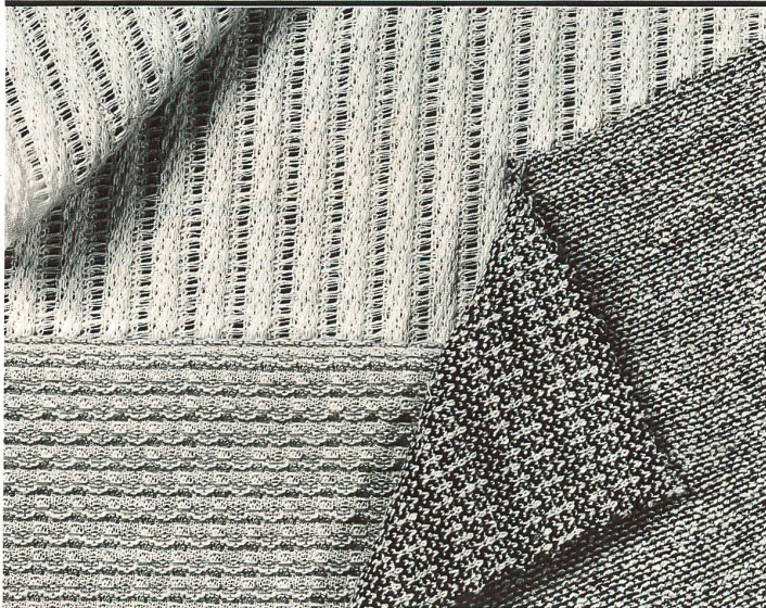
Beispiele von neuen Maschenstoffen aus reiner Baumwolle und Seide / Exemples de nouveaux articles maillés en pur coton et en pure soie / New knitted fabrics in pure cotton and silk. (Gugelmann + Co. AG, Dept. Jersey, Langenthal)
