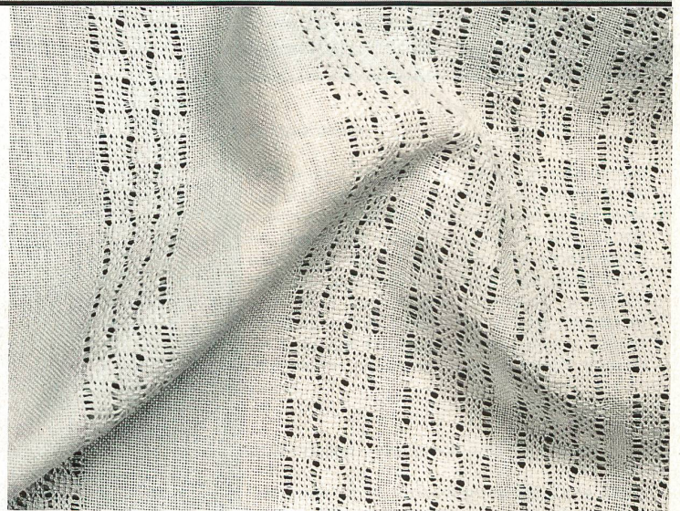
Stark durchbrochenes Baumwoll-Dreher-Gewebe mit abgesetztem Band / Batiste avec effets d'armure gaze et bande séparée / Cotton open-work gauze-weave fabric with attractive band. (Hausammann + Moos AG, Weisslingen)
