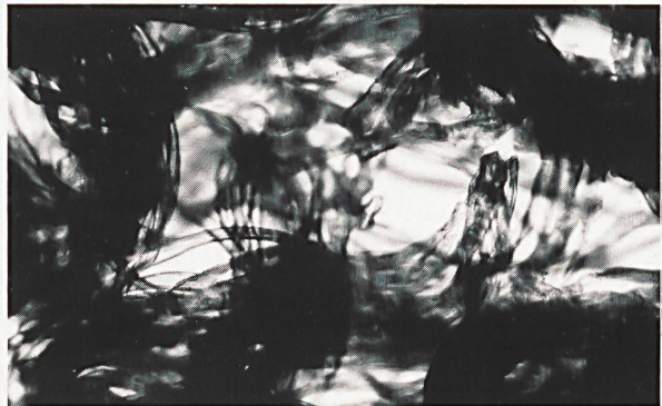
Schmelzschäden in Polyamid-Maschenware / Dommages dus à la fusion sur maille en polyamide / Melt damage in polyamide knitted goods.
