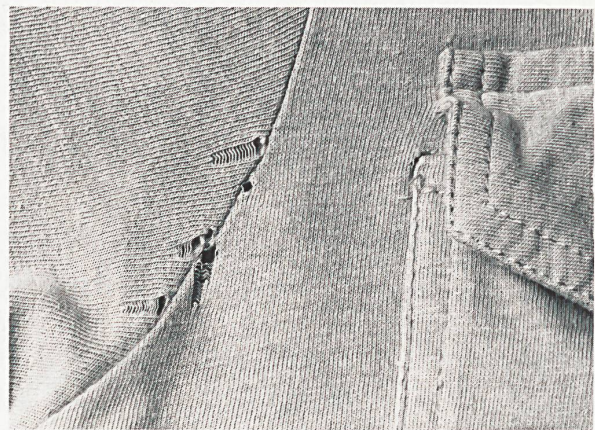
Maschensprengschäden auf Baumwolltricot / Mailles éclatées sur tricot de coton / Stitch breaks on cotton tricot.
