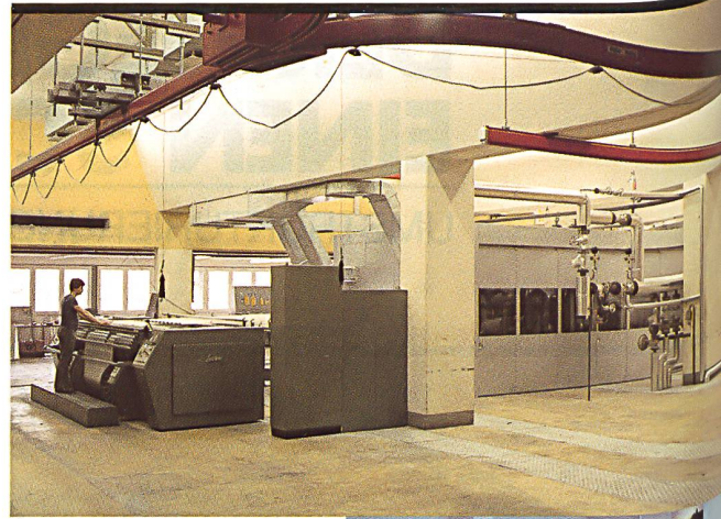
△ Bütschwil: Modernste Schlicht-Maschine mit Wärmerückgewinnung / Encolleuse moderne avec système de récupération thermique / Latest smoothing machine with heat recovery. ▷ Labor Qualitätssicherung / Laboratoire chargé des contrôles de qualité / Quality testing laboratory.
