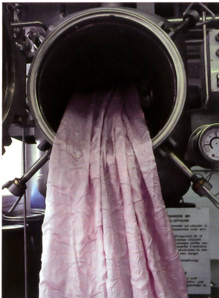
Interspitzen AG, Oberbüren Färbe-Apparat, Overflow
