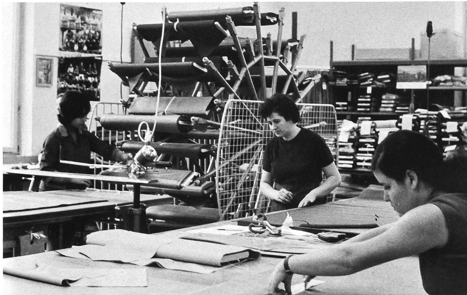
Futterkarussell – 30 verschiedene Futterfarben können durch Knopfdruck an ihren Arbeitsplatz geführt werden
