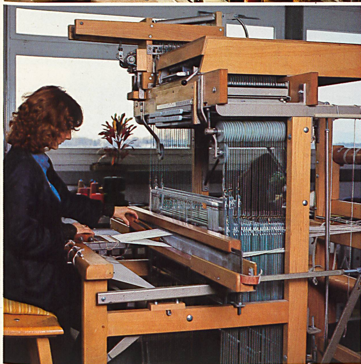
Musterwebstuhl mit 28 Schäften und Drehvorrichtung / Métier à tisser d'échantillonnage à 28 lames et dispositif pour armure simili-gaze / Loom for the making up of patterns with 28 heddles and gauze device / Telaio modello con 28 licci e dispositivo da giro.
