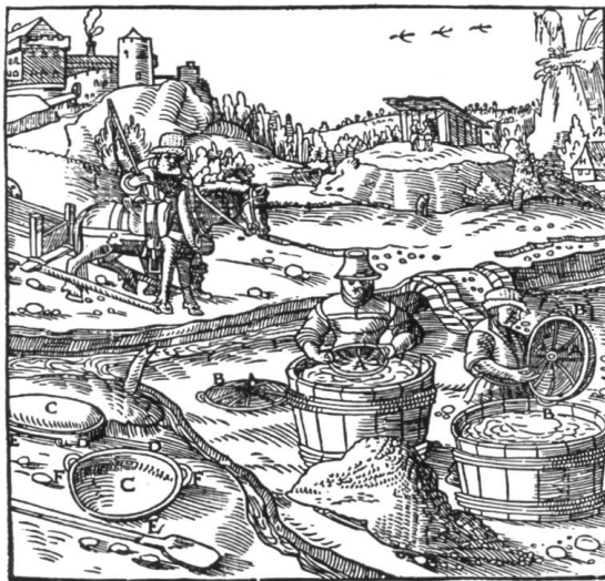
Abb. 4 Bohnerzwaschen (Holzschnitt aus: Georg Agricola, Basel 1556).
