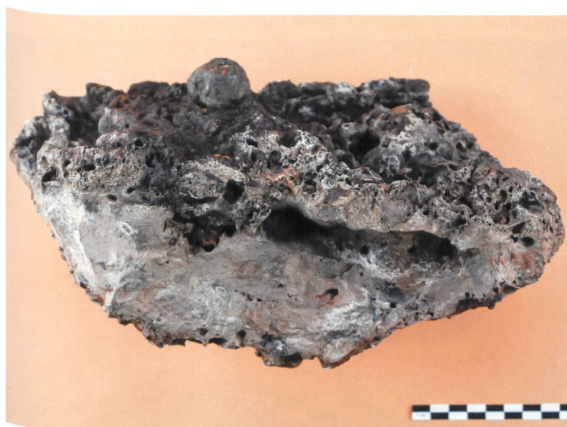
Abb. 20 Bruchstück einer Eisenerzverhüttungs- schlacke.
