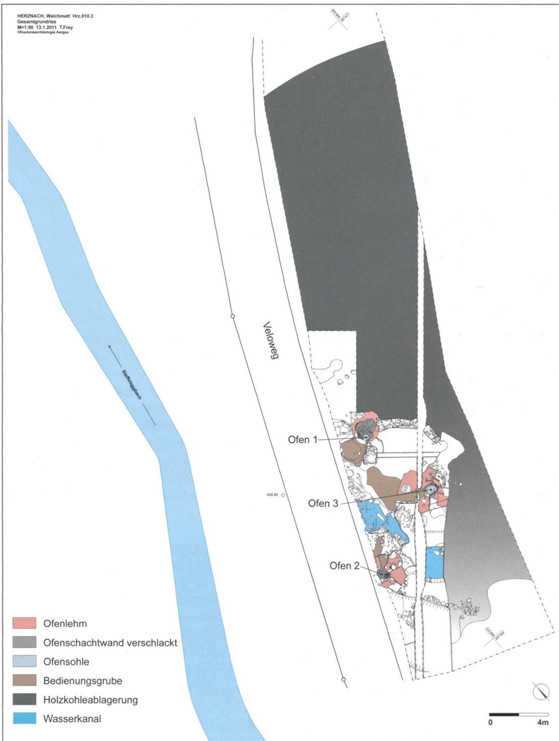
Abb. 6 Übersichtsplan der Eisenerzverhüttungs- anlage.
