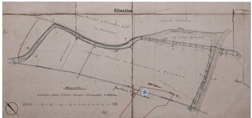
Abb. 5b Der Mühlekanal auf dem Situationsplan «Bachkorrektur beim Hirschen» von 1876. Rot Parzelle Nr. 193, in deren Westhälfte die Grabung stattfand; ★ ungefähre Lage der Stauvorrichtung.
