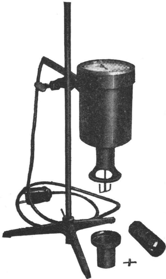
DRAGE Precision - Torsion - Viscosimeter
