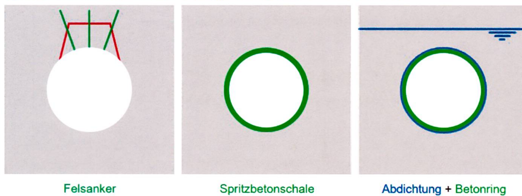
Fig. 2: Einwirkung und Auswirkung im Untertagbau.
