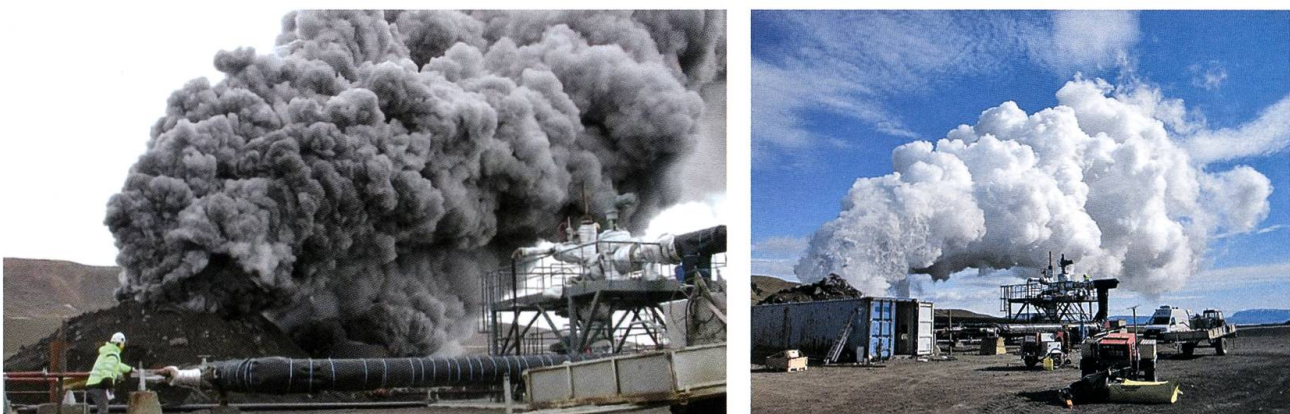
Fig. 4: Links: IDDP-1 Bohrloch wenige Minuten nach dem ersten Öffnen: heftiges Ausströmen von sehr heissem Dampf; die graue Farbe rührt von Gesteins- und Metallpartikeln her, die bei der Heftigkeit des Ausströmens im Bohrloch mitgerissen wurden. Nach etwa einer halben Stunde hatte sich ein dynamisches Gleichgewicht eingestellt, bei dem überhitzter klarer Dampf austritt, der an der kühlen Luft zu weissem Wasserdampf kondensiert (rechts). Die Temperatur am Bohrlochkopf erreichte fast 450 °C. Bilder: G.O. Fridleifsson, IDDP-Projektleiter, mit freundlicher Genehmigung.
