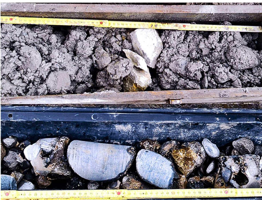
Fig. 3: Bohrkern aus dem Aathal-Schotter, oben mit Einfachkernrohr gebohrt (mit erhöhtem Feinanteil), unten mit Doppelkernrohr (Ton-, Silt- und Sandfraktion ausgespült).
