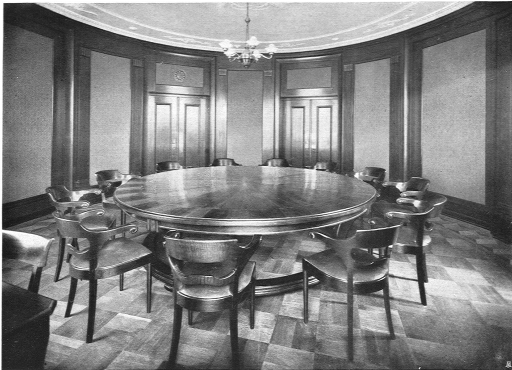
Bankgebäude Biel, II. Stock, Sitzungszimmer. Arch. Saager & Frey, Biel; Wandtäfer in Nußbaum matt poliert mit Damast-Füllungen, Mobiliar Nußbaum matt poliert, Hugo Wagner, Werkstätten für Innen-Einrichtung S.W.B., Bern
