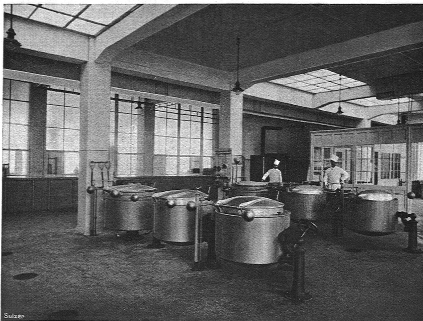
Dampfküche mit 18 Sulzer-Kochkesseln von zusammen 2100 Liter Inhalt, für 0,4 Atm. Betriebsdruck.]
