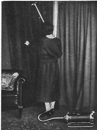
Abb. 20. »Electro-Lux«-Staubsauger auf Schlitten.
