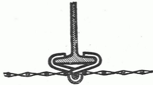
Abb. 6. Befestigung von Rauchs Reformrabitzen an eisernen T-Balken.
