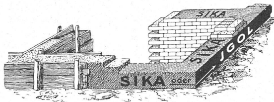
Abb. 10. Schema für Sika-Horizontalabdichtungen.
