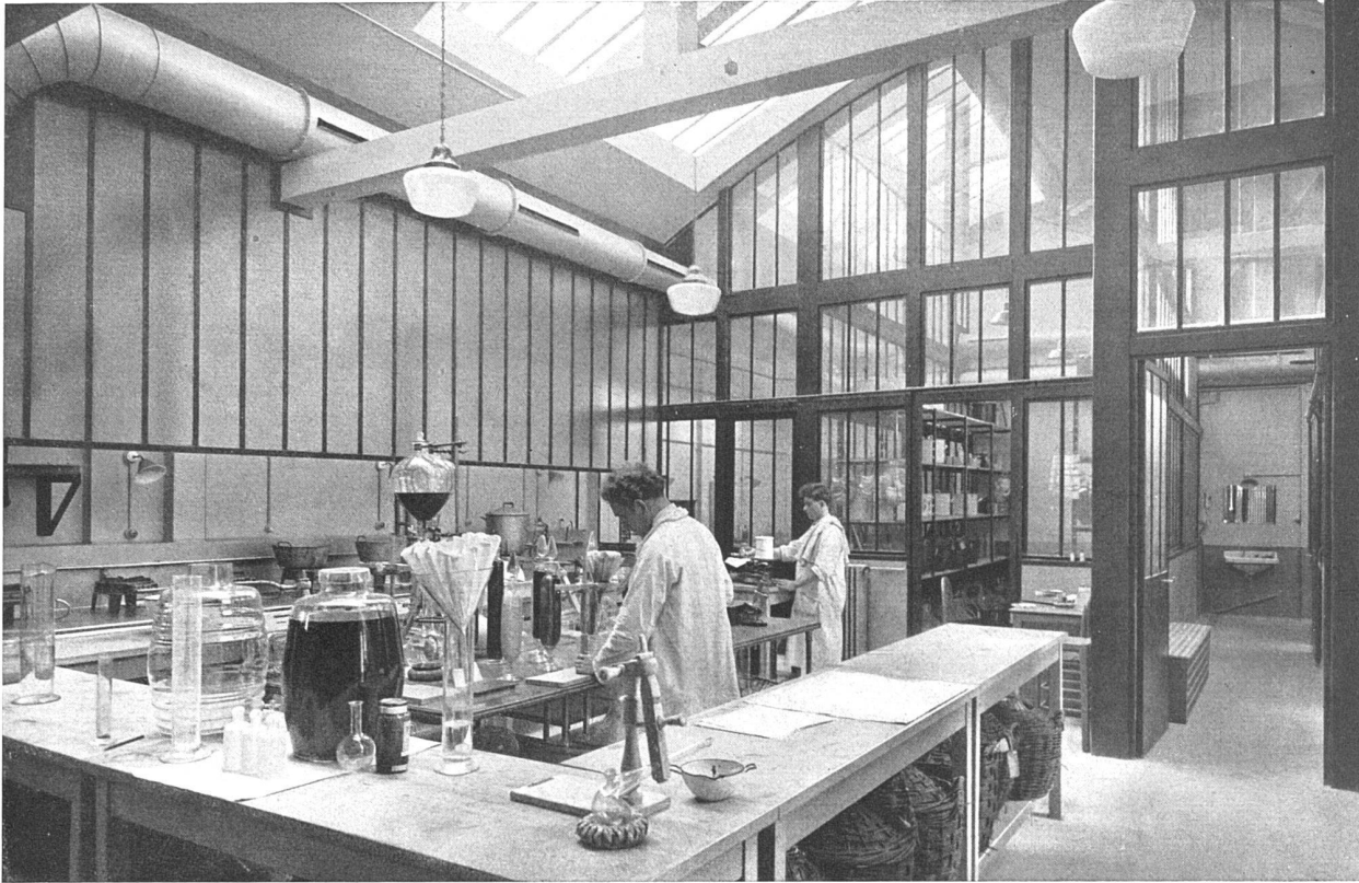
Laboratoriumsküche, wegen ihrer Feuergefährlichkeit in besonderem Anbau
