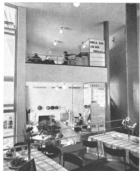
Z-Restaurant, Ecke Rebgasse-Müllerstrasse Aeusserste Ausnützung der sehr ungünstig geformten Eckparzelle. Rund 140 Sitzplätze in drei Höhenlagen, das Podium im Vordergrund ermöglicht gute Belichtung und Belüftung der darunterliegenden vollelektrisch eingerichteten Küche
