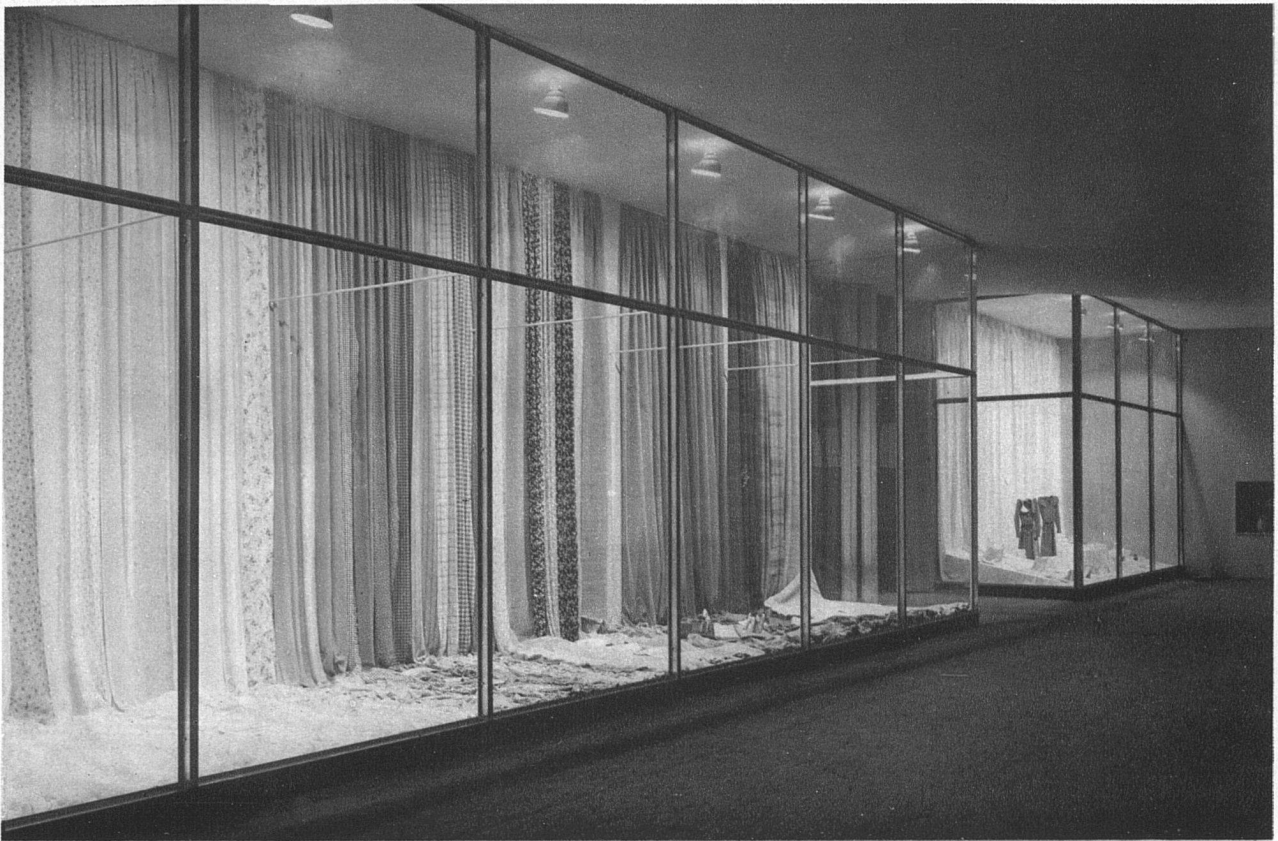
Textilvitrinen, resedagrüner Spannteppich, Wände und Decke mit elfenbeinfarbenem Reps bespannt, Vitrinenrahmen in Antikorodal Intérieur du salon des textiles, tapis réséda, parois et plafond tendus d'étoffe ivoire, armature des vitrines en «anticorodal»
