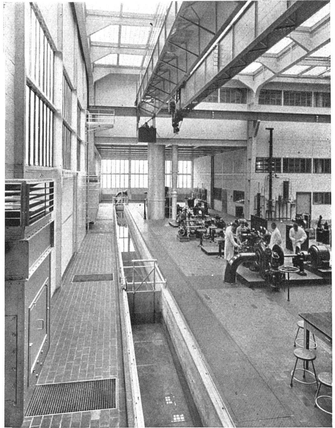
Turbinen, Pumpen, hydraulisches Laboratorium mit 38,5 m langer Versuchsrinne an der Südseite der grossen Maschinenhalle, gegen Westen gesehen
