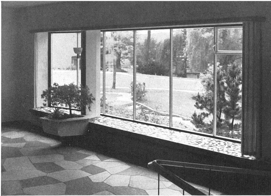
Eingangshalle, Bodenbelag aus Granit, Quarzit und Serpentin, Fenstersims auf Sitzhöhe mit farbigem Mosaikbelag / Hall d'entrée; Sol en dalles de granit, quartzite et serpentine; les bords des fenêtres, en mosaïque, servent de bancs / Entrance-hall; flooring of granite, quartzite and serpentine; the children can sit on the coloured mosaic window-sill Sämtliche Photos O. Pfeiffer SWB, Luzern
