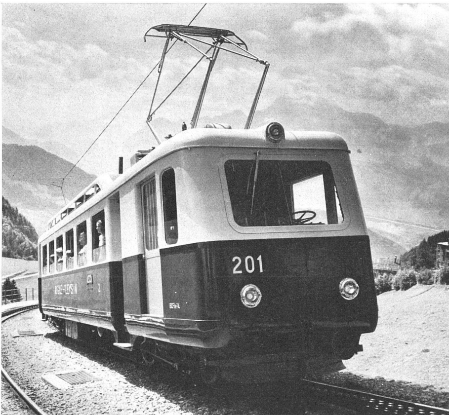
Elektrischer Triebwagen. Formgebung gekennzeichnet durch sorgfältige Bearbeitung aller Teile. Zahnrad-Triebwagen der Aigle-Leysin-Bahn. Hersteller: Brown, Boveri & Cie. AG., Baden, und Schweiz. Lokomotiv- und Maschinenfabrik Winterthur (Schweiz) | Automotrice électrique à crémaillère; l'unité de la forme correspond bien à la mobilité du véhicule | Electric motor-coach; careful design of all parts
